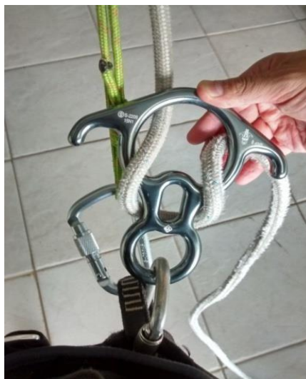
Prussik conectado ao ilhós do baudrier por mosquetão
